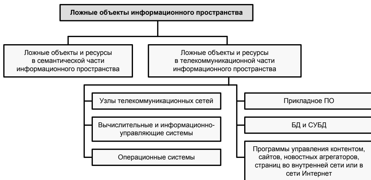
Рис. 4.11. Классификация ложных объектов информационного пространства
