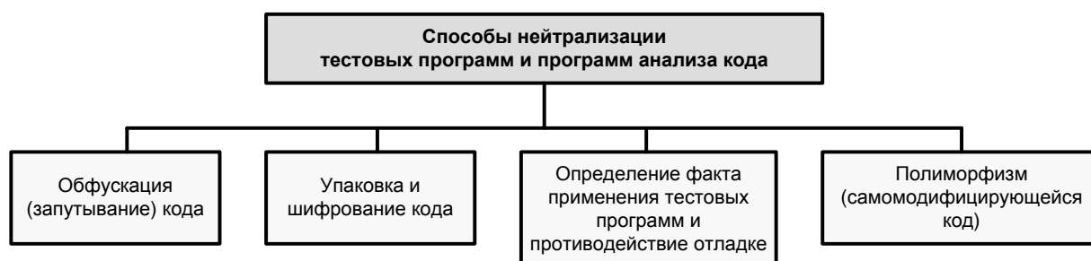
Рис. 4.10. Классификация способов нейтрализации программ
