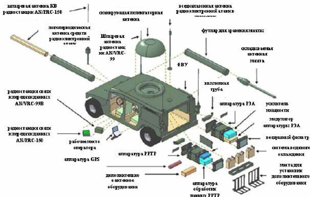
Рис. 3. Состав аппаратуры наземного компонента комплекса
