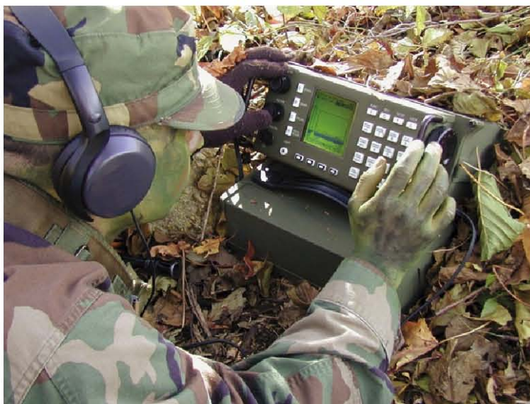
Рис. 2. Приемник-анализатор переносной станции AN/PRD-13(V)5 в течение 72 ч.
