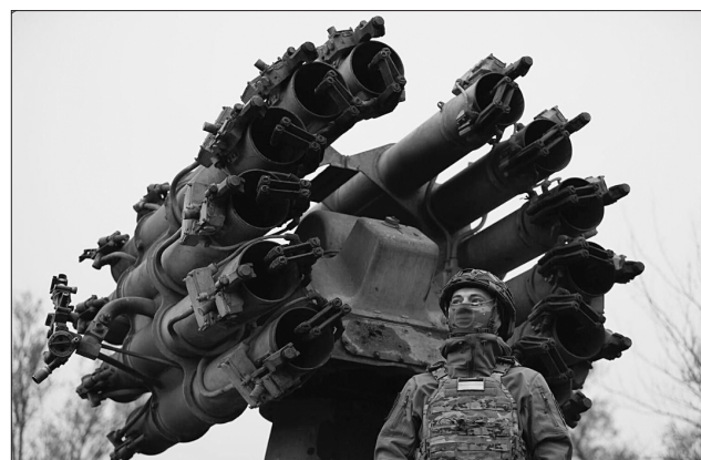
Рис. 7. Реактивно-бомбометная установка РБУ-6000 «Смерч-2» в сухопутных условиях [23]
