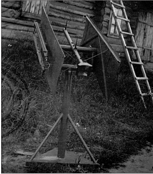
Рис. 5. Установка 4-х балочной батареи ракетных орудий конструкции инженер-капитана Борисюка В.А.
