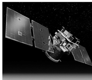
КА - «орбитальный радар» с ФАР миллиметрового диапазона и баллистическое построение орбитальной группировки на круговой полярной орбите высотой 1000 км
