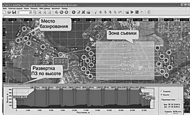
Рис. 4. Участок поиска на экране монитора оператора БПЛА [6]
