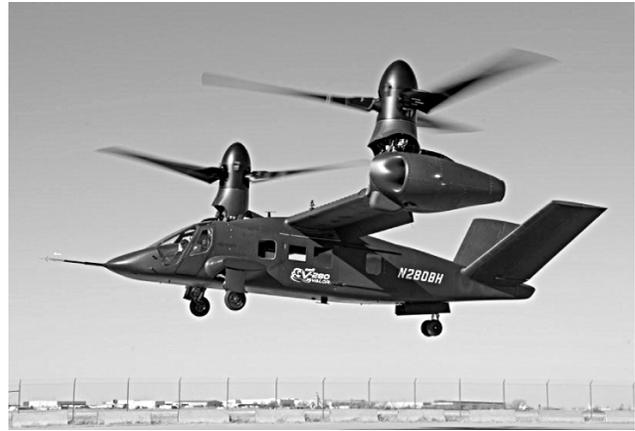
Рис. 3. Конвертоплан с поворотными винтами V-280 Valor
