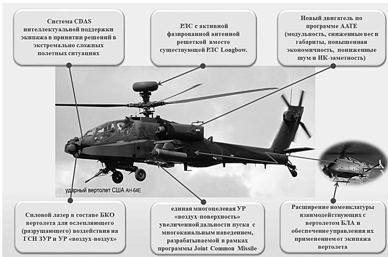
**Рис. 1. Основные направления дальнейшей модернизации ударного вертолета AH-64E в вариант AH-64F (Block IV)**
