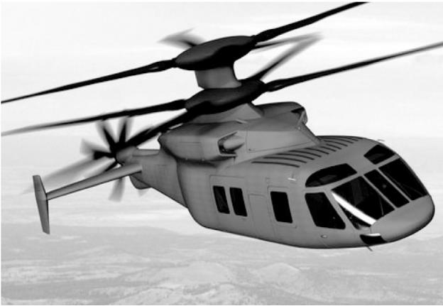
Рис. 2. Скоростной вертолет соосной схемы SB-1 Defiant
