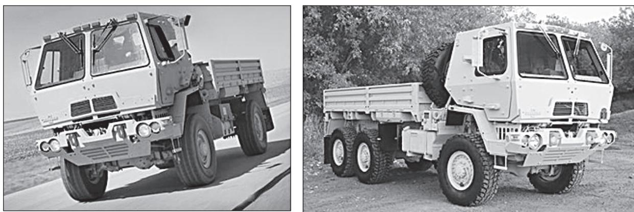
Рис. 6. Семейство средних тактических автомобилей Oshkosh FMTV с бронированной кабиной
