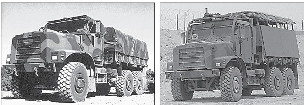
Рис. 5. Средние тактические автомобили Oshkosh MTVR (6x6)
