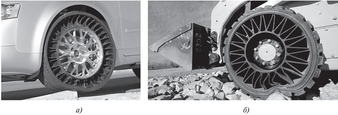
**Рис. 2. Колеса с безвоздушными шинами Michelin Tweel: а – Michelin Tweel на легковом автомобиле Audi A4; б – Michelin Tweel на фронтальном погрузчике CAT Loader**
