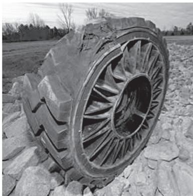
**Рис.3. Колесо с безвоздушной шиной Michelin X-Tweel SSL после подрыва на mine**
